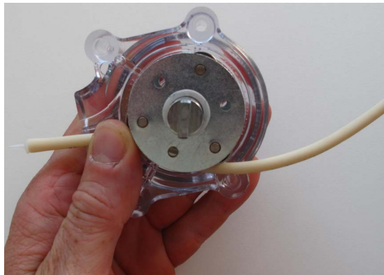
Abb. 5-16: Schlauch auf die Vertiefung legen
