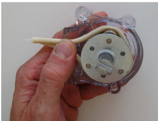
Abb. 5-20: Pumpschlauch in der Vertiefung
