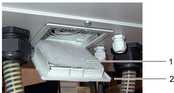
Abb. 5-8: Untere Filtermatte wechseln
