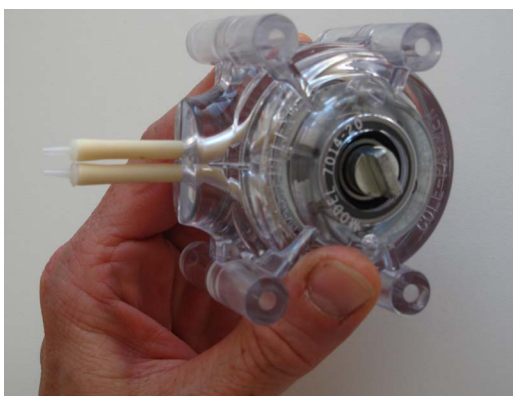
Abb. 5-21: Oberteil des Pumpenkopfs aufsetzen
